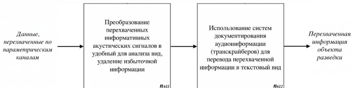
Рис. 2. Функциональная диаграмма декомпозиционного представления режима приведения данных, перехваченных по параметрическим каналам, к формату, позволяющему осуществлять их обработку в операционной среде СВТ технического средства разведки
